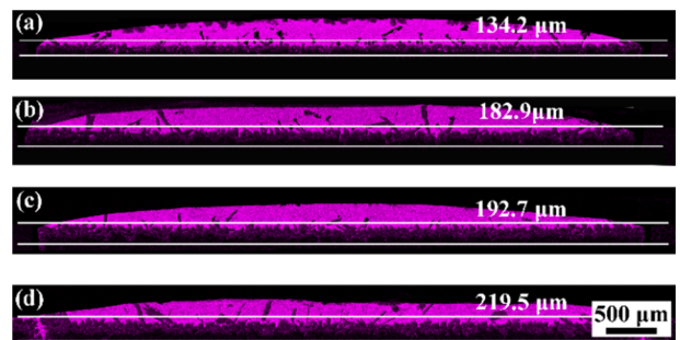
图 12 ( \text{Y}_{0.2}\text{Gd}_{0.2}\text{Ho}_{0.2}\text{Er}_{0.2}\text{Yb}_{0.2} ) _3\text{Al}_5\text{O}_{12}/\text{Al}_2\text{O}_3 共晶陶瓷在 1500 °C 经 CMAS 腐蚀不同时间后的 Ca 元素分布情况 [102]
