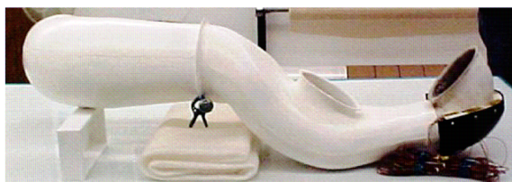
图7 轻型直升机 Al 2 O 3 f/Al 2 O 3 复合材料尾喷管 [70]
