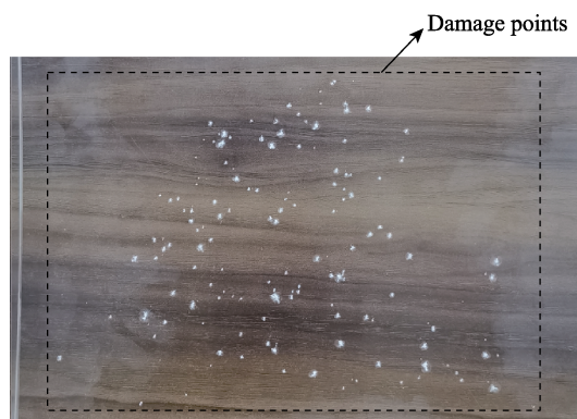
图 1 含损伤点熔石英玻璃真空窗口光学元件照片
