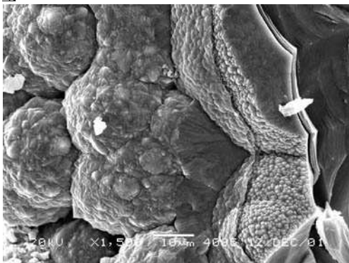
图 5 SiC 涂层表面及内部结构显微照片
