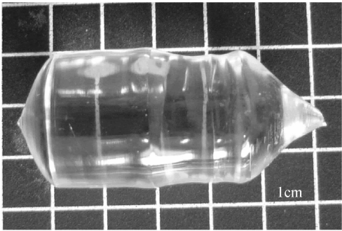
图 1 沿 a 轴生长的 \text{SrWO}_4 单晶 Fig. 1 \text{SrWO}_4 single crystal grown along a -axis direction
