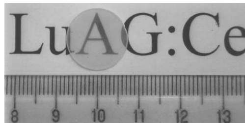
图 5 双面抛光的 Ce:LuAG 陶瓷的实物照片 (1.2mm 厚)
