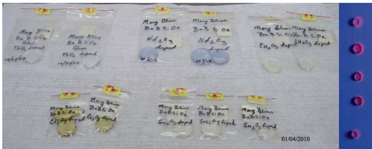
图 9 PNNL PNNL 稀土离子激活的钍玻璃闪烁丸(a)及其在紫外激发下的荧光(b) [41]
