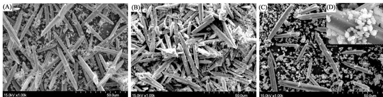
图 2 套用回收液 A 制备针状碳酸钙产品的形貌
