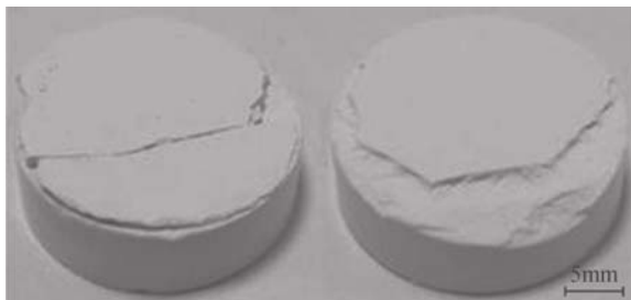
图 6 素坯样品层裂图
