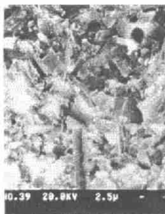
图 2 Y- \alpha/\beta -Sialon 断口表面的 SEM 照片 Fig.2 SEM micrographs of fracture surface of Y- \alpha/\beta -Sialon
