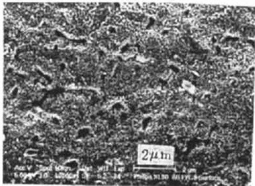
图 6 沉积金刚石薄膜后的硬质合金刀片表面形貌
