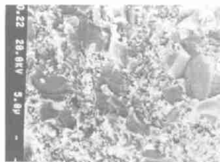
图 6 TiC, TiB 2 两相含量为 30 vol% 时复合材料的断口照片
