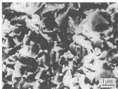
图 3 FTC1 试样断口形貌
