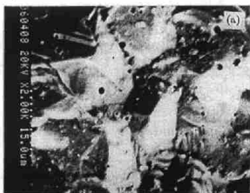
图 5 1550^\circ\text{C} 、8h 烧结试样的断面形貌照片
