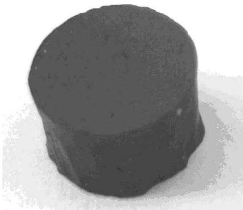
图 3 表面抛光后的烧结试样
