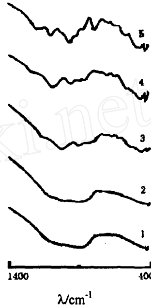
图 2 微晶玻璃的红外光谱
